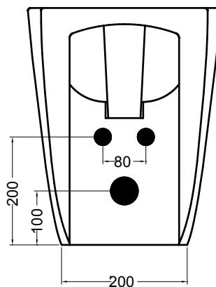
N.B.: Le misure indicate possono subire una variazione dello 0,8 % circa, dovuta ad usura stampi o a piccole variazioni delle caratteristiche tecniche relative alle materie prime che compongono l' impasto.
