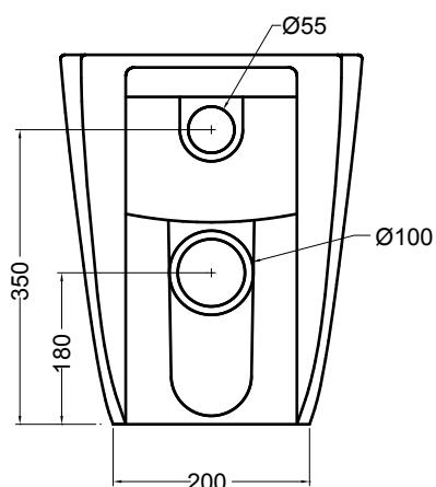
N.B.: Le misure indicate possono subire una variazione dello 0,8 % circa, dovuta ad usura stampi o a piccole variazioni delle caratteristiche tecniche relative alle materie prime che compongono l' impasto.
