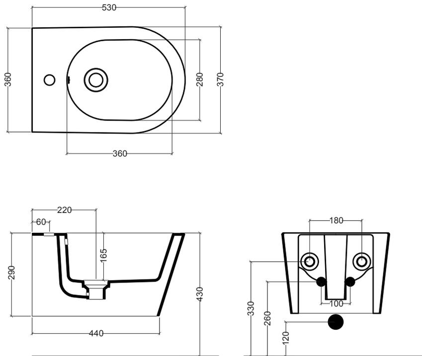
N.B.: Le misure indicate possono subire una variazione dello 0,8 % circa, dovuta ad usura stampi o a piccole variazioni delle caratteristiche tecniche relative alle materie prime che compongono l' impasto.
